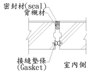
圖 R10.6 標準層垂直接縫圖例 (平剖面)
