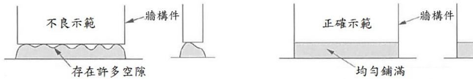
圖 R8.10 底鋪水泥砂漿之不良及正確示範<sup>[8.4]</sup>
