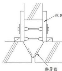
圖 R8.5 單縫模板上視圖例<sup>[8.4]</sup>
