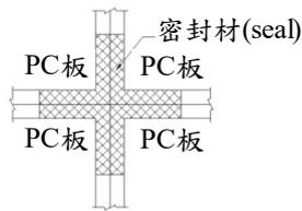
圖 R10.7 標準層十字接縫圖例
