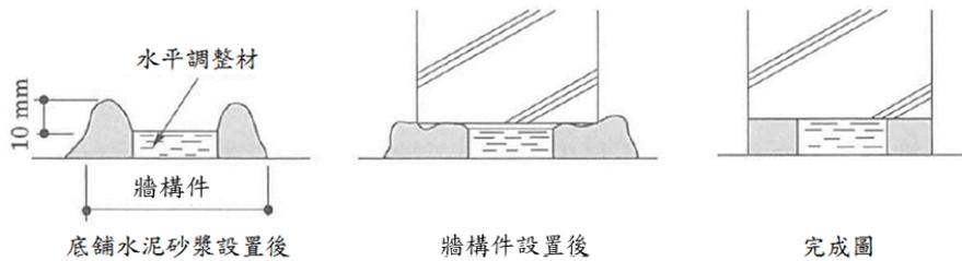
圖 R8.11 底鋪水泥砂漿之施工<sup>[8.4]</sup>
