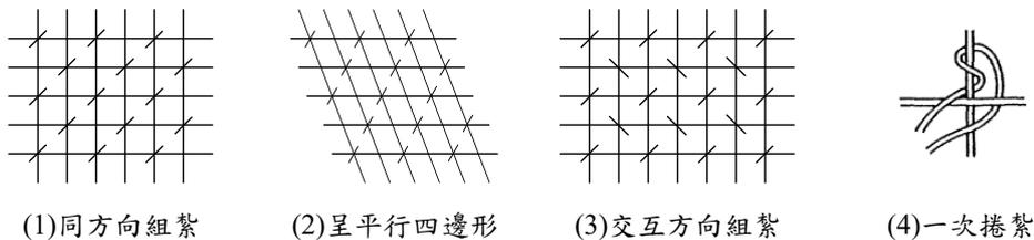
圖 R5.2 鋼筋綁紮之方向<sup>[5.1]</sup>
