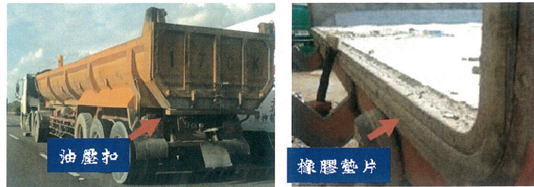
圖 7、貨箱設置防止廢水滴落設施
