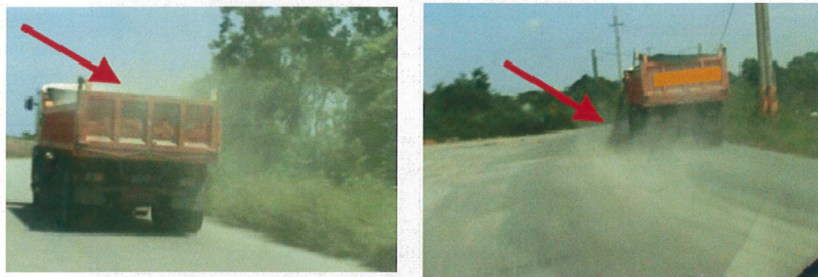
圖 5、土石運輸車輛未覆蓋貨箱造成揚塵
