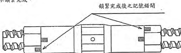
圖 6.9 鎖緊完成後之記號的錯開
