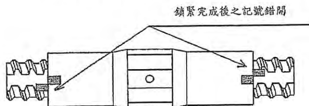
圖 6.10 鎖緊完成後之記號的錯開
